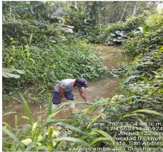
Foto 1. Río Guacharaco, (aguas arriba, después del proyecto) Descripción de características físicas, hidrológicas y organolépticas; Toma de muestras de macroinvertebrados acuáticos, con red tipo D multihábitat.
